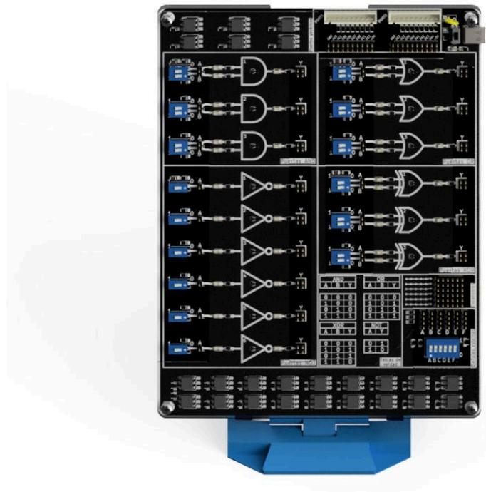
Este kit está diseñado para tener la posibilidad de utilizarlo manualmente alimentándose con ayuda de un cable USB de tipo C y permite a los usuarios crear proyectos de electrónica digital de manera eficiente y efectiva gracias a los interruptores de cambio de estado de las entradas de las puertas.
