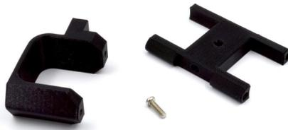
Se une la estructura del soporte de batería con el soporte motor, haciendo uso del agujero central y el tornillo autorroscante negro (referencia J), quedando como muestra la siguiente imagen.
